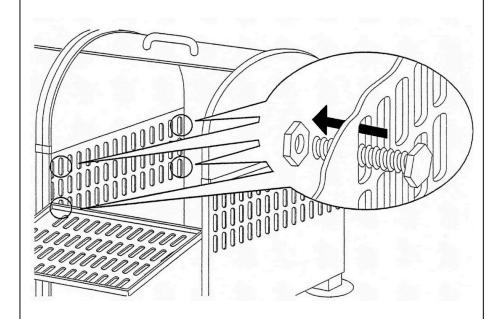
●環境ステーションを連結して使用する際には側面のスリット部分の、四隅のできるだけ端を付属のボルト・ナットでしっかりと留め、固定されていることを必ず確認してください。
